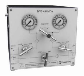
Блок подготовки воздуха ЭЛМЕТРО-БПВ применяется для дополнительной очистки и осушения воздуха, используемого для питания эталонов давления, например контроллеров-калибраторов ЭЛМЕТРО-Паскаль, РАСЕ 5000, РРС4, калибраторов серии "Воздух", газовых грузопоршневых манометров и др. Выполняет функции защиты контроллеров и эталонов давления от загрязнений, попадающих из полости поверяемых приборов. Позволяет предотвратить поломку контроллеров давления.
