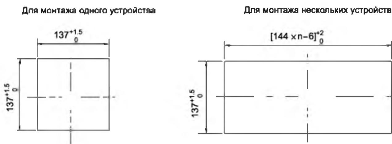
Примечание: при монтаже панели необходимо зафиксировать самописец крепежными скобами сверху и снизу
