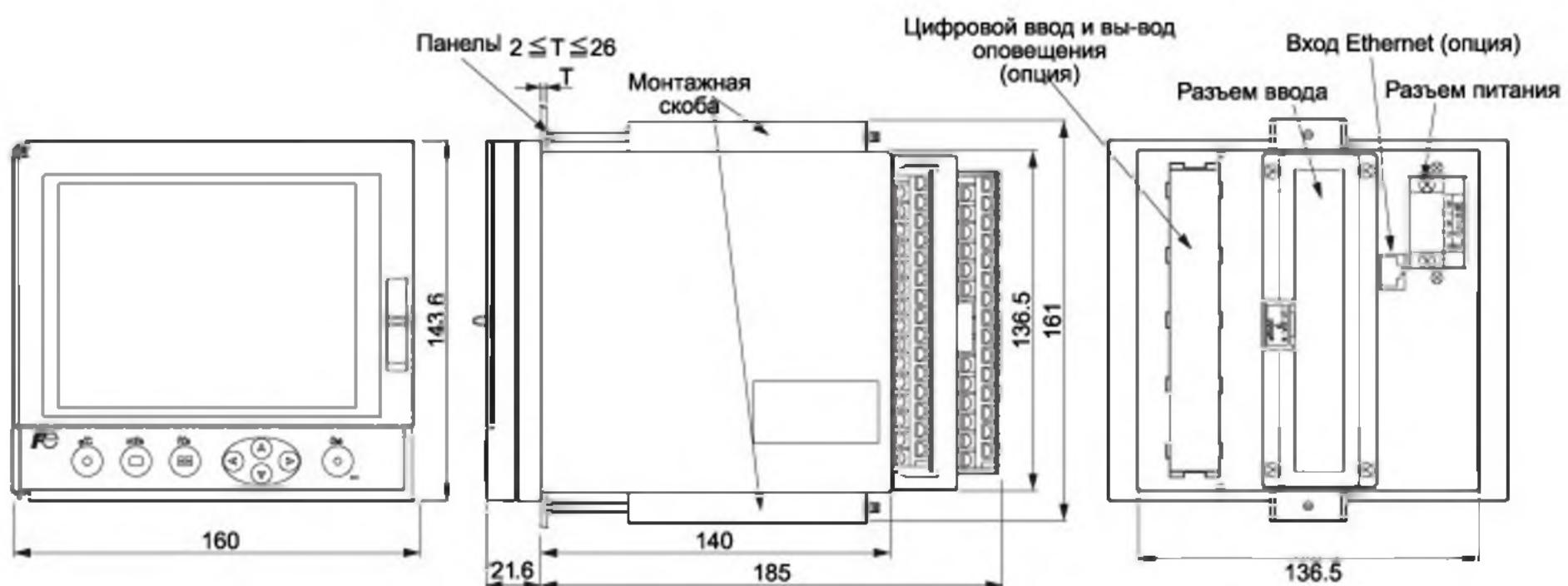
Примечание: при монтаже прибора вблизи пола или нескольких приборов рядом необходимо оставить между ними зазор не менее 100 мм.
