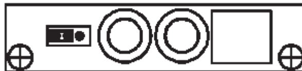
Рисунок 8-Положение переключки для режима “HART модем”
