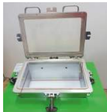
Рис. 10д. Вариант размещения барокамеры в отдельном каркасе для оборудования уже готового рабочего места для поверки барометров
