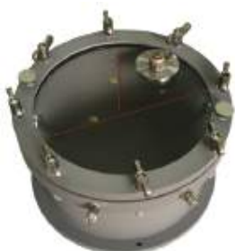
Рис. 10б. Камера круглая со смотровым стеклом и гермовводом
