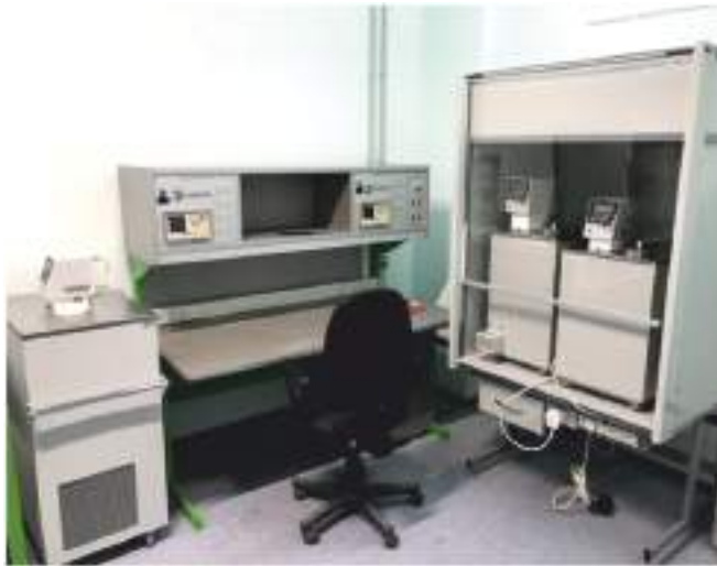
Рис. 15. Стенд поверки, калибровки и ремонта преобразователей температуры
