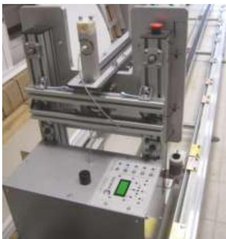
**Стенд для поверки и калибровки средств измерений уровня ЭЛМЕТРО-СПУ** предназначен для воспроизведения единицы длины при измерении уровня, имитации или непосредственного измерения уровня жидкости. ЭЛМЕТРО-СПУ применяется для поверки, калибровки, градуировки и испытаний радарных, поплавковых, ультразвуковых, коаксиальных, радиоволновых и др. типов уровнемеров.
