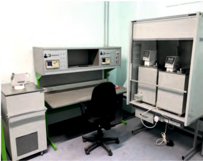
Рис. 15. Стенд поверки, калибровки и ремонта преобразователей температуры
