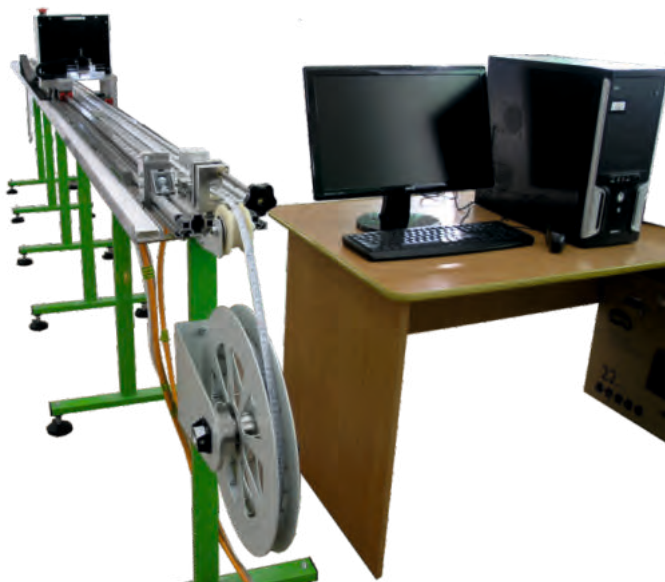
Рис. 22. Метрологическая установка для измерения длины ЭЛМЕТРО-ЛИЗА
