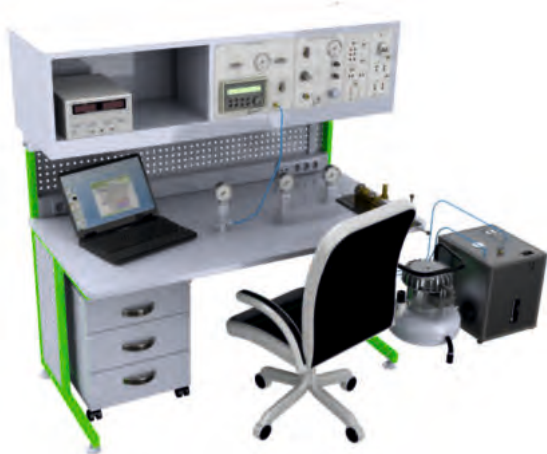
Рис. 5. Автоматизированный метрологический стенд поверки, калибровки и ремонта датчиков давления на базе калибраторов-контроллеров давления ЭЛМЕТРО-Паскаль и мультиметра ЭЛМЕТРО-Кельвин
