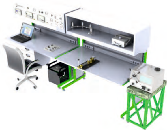
Рис. 6. Полуавтоматизированный метрологический стенд поверки, калибровки и ремонта манометров на базе калибратора давления ЭЛМЕТРО-Паскаль-02
