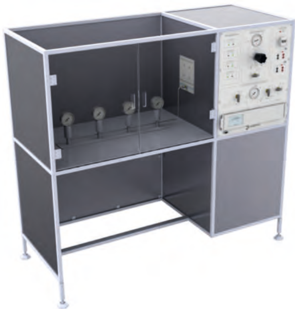
Рис. 7. Стенд поверки датчиков давления на базе контроллера WIKA CPC-6000 в региональном ЦСМ
