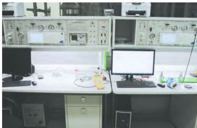
Рис. 8. Стенды поверки датчиков давления на базе контроллера DRUCK PACE 6000, для локализации производства в России
