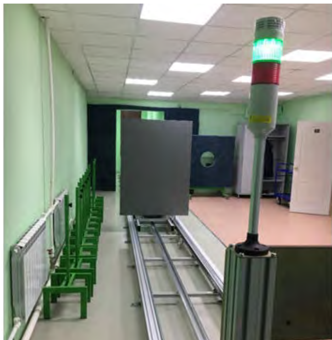
Рис. 19. Стенд поверки, калибровки и ремонта радарных, рефлекс-радарных, ультразвуковых, поплавковых и волноводных в т.ч. тросовых уровнемеров. Стенд сдан и запущен в промышленную эксплуатацию в компаниях западной Сибири, Р. Татарстан и регионального ЦСМ Поволжья
