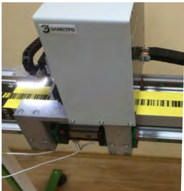
Рис. 23. Метрологическая установка для измерения длины ЭЛМЕТРО-ЛИЗА
