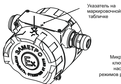
Рис. 2. Положение магнитной точки для тестирования выхода
