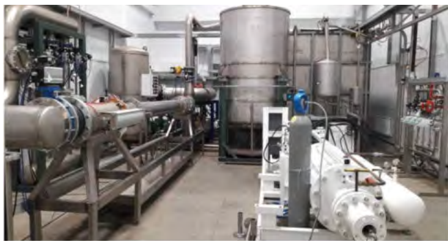
Рис. 24. Установка поверочная проливная расходом 600 м 3 /час
